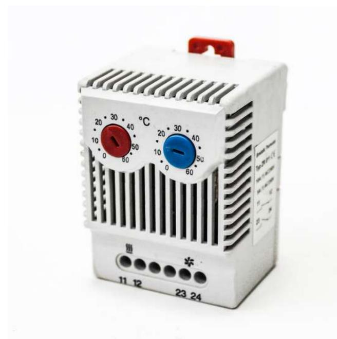
Терморегулятор совмещает в одном корпусе контакт нормально закрытый - для управления обогревателями, и контакт нормально открытый - для управления вентиляторами фильтрующими, оборудованием охлаждения и сигнальными устройствами. Степень защиты IP 20, номинальное напряжение 120, 230(AC), 24-72 (DC), частота тока 50/60.
