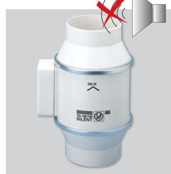
У модели TD-160/100N SILENT электродвигатель крепится к корпусу при помощи резиновых "сайлент-блоков", которые предотвращают передачу вибрации на корпус вентилятора. Такая конструкция позволяет достичь низкого уровня шума без применения особого звукоизолирующего корпуса.
