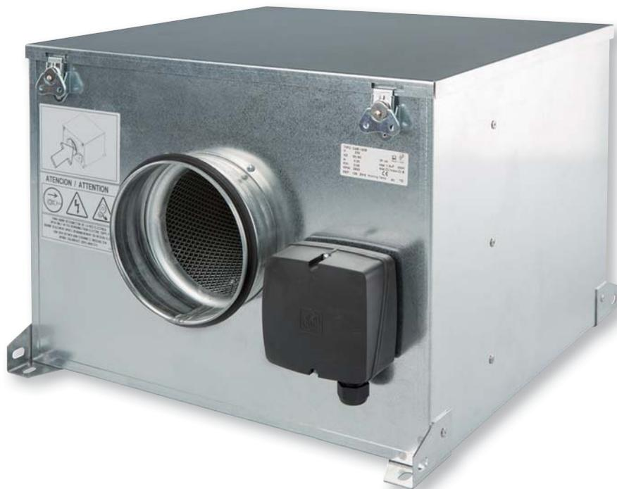
Низкопрофильные вентиляторы в шумоизолированном корпусе из оцинкованной листовой стали с теплозвукоизоляцией из негорючего стекловолокна (М0) толщиной 50 мм. Воздушный канал со стороны входа воздуха также шумоизолирован.
