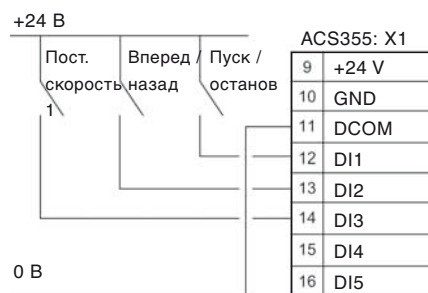
Конфигурация цифровых входов (DI) (подключение PNP) с внешним источником питания (источник)
