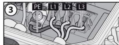
Abb. 2: Anschluss der Leitungen an Klemmen
