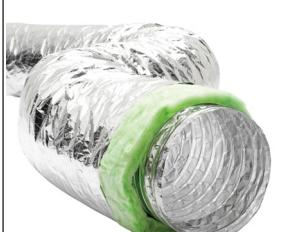
Воздуховоды **ISOAFS-ALU GREEN** представляют собой гибкие изолированные алюминиевые воздуховоды. Максимальное рабочее давление 3000 Па. Максимальная скорость потока 30 м/с.
