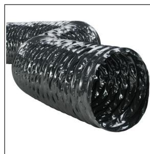
Воздуховоды **PEAFS** представляют собой неизолированные гибкие полиэтиленовые воздуховоды со спиральным каркасом из стальной проволоки. Максимальное рабочее давление 2000 Па. Максимальная скорость потока 30 м/с.
