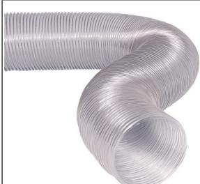
Воздуховоды **VINYLAFS TRANSPARENT** представляют собой гибкие неизолированные ПВХ воздуховоды со спиральным каркасом из стальной проволоки. Максимальная скорость потока 30 м/с.
