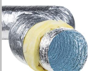
Воздуховоды **ISOAFS-ALU HYGIENE** представляют собой гибкие теплоизолированные алюминиевые антибактериальные воздуховоды. Максимальное рабочее давление 3000 Па. Максимальная скорость потока 30 м/с.
