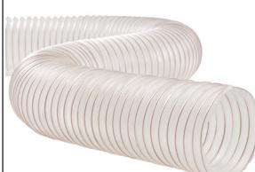
Воздуховоды **AFSTPU** представляют собой неизолированные гибкие воздуховоды из полиэстер-полиуретана со спиральным каркасом из стальной проволоки с медным покрытием. Максимальная скорость потока 30 м/с.
